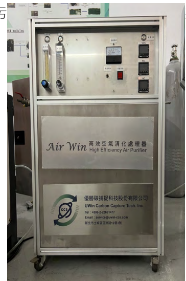
圖 3 Air-Win 高效質傳反應器
